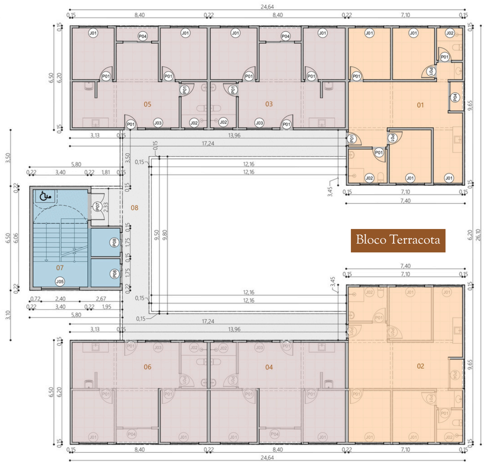
Figura 23 - Planta Baixa Bloco Residencial Terracota Fonte: Autoria Própria
